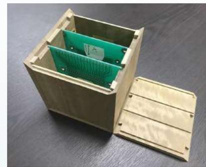
宇宙空間で小型衛星の筐体(構造と外殻)に木材利用するための実験中
